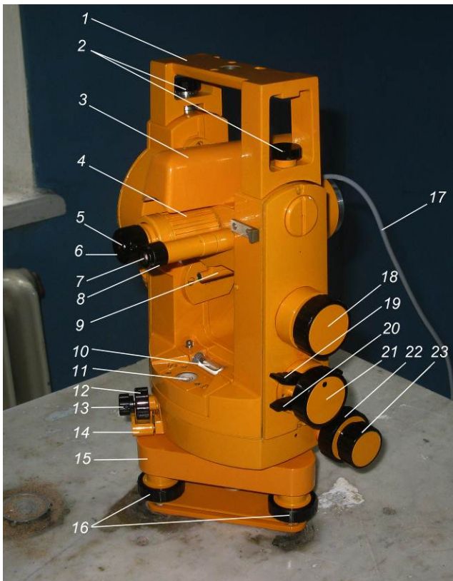
Рис. 1. Феррозондовый деklinометр/инклинометр на основе немагнитного теодолита Carl Zeiss Theo 010B.
